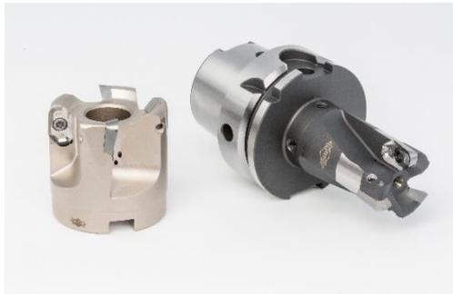
Bild 3: Hochwirtschaftliche Lösung bei größeren Durchmessern: Der Wendeschneidplattenfräser NeoMill-Alu-QBig steht für große Zeitspanvolumina bei geringen Schnittkräften und hohen Oberflächengüten. ©MAPAL
